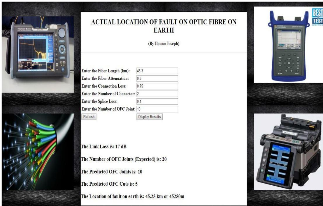
**ACTUAL LOCATION OF FAULT ON OPTIC FIBRE ON EARTH**
